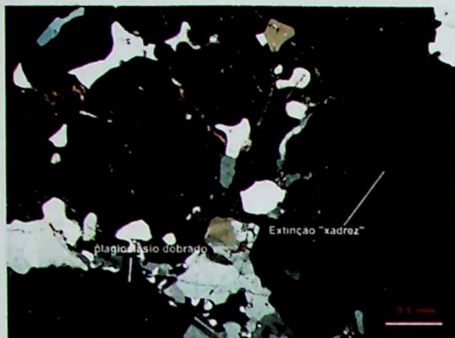
Figura 7.3 – Amostra AR 535. Deformações intracristalinas em quartzo e plagioclásio. Polarizadores cruzados.
